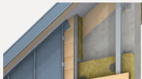
Haut de bardage sous rampant
